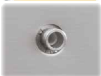
Kijkgat in de ovendeur (diameter 20 mm)
