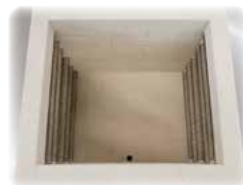
Verwarmingselementen op draagbuizen zorgen voor een vrije warmteafstraling
